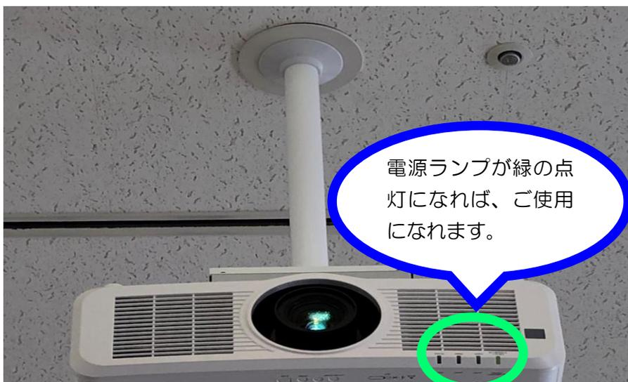
このプロジェクターの光源は、レーザー光源です。レーザー光源の投写が目に入った場合でも、レンズによる集光で網膜を損傷させる危険性は、他の光源（ランプ光、LED光）の場合と同様に低いと考えられています。
