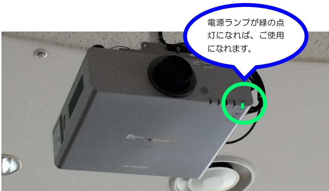
ご使用後は VP 電源を先に切り、約3分冷却時間(電源表示ランプが
