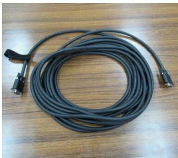
AV 機器接続パネルの **PC-1** (RGB 入力端子) または **PC-2** (RGB 入力端子) にケーブルを接続し、パソコン側の RGB 出力端子にもケーブルを接続します。
